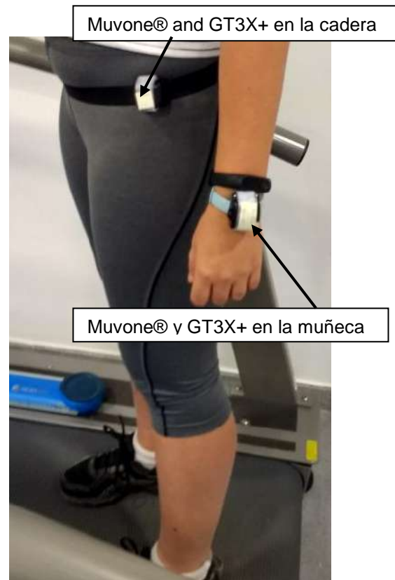
Figura 1. Acelerómetros Muvone® y GT3X+ adyacentes y pegados, colocados sobre la cadera y la muñeca no dominantes.
