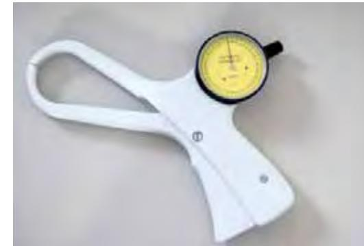
Figura 12. Plicómetro o compás de pliegues utilizado. Marca Slim Guide (0 - 80 mm).
