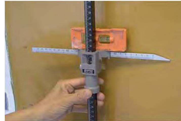
**Figura 10.** Antropómetro marca GPM (0 mm - 950 mm). Para la longitud de segmentos posición igual que en diámetros..
