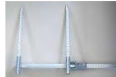
**Figura 8.** Antropómetro GPM grande de ramas curvas y puntas romas. Siber Hegner (0 - 600 mm).
